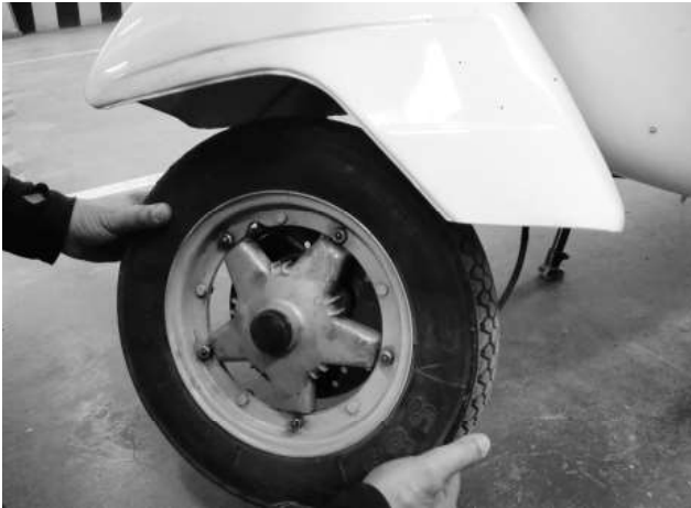
4. Comprobación de la holgura de los cojinetes del cabezal de dirección.
