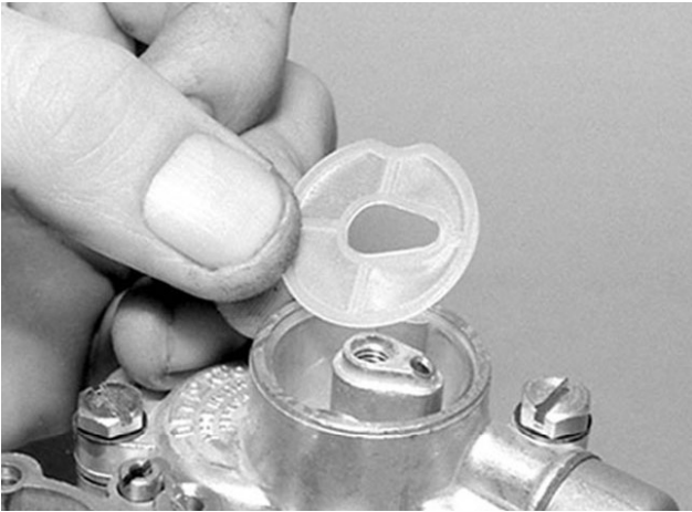
6.2b. .... para acceder al filtro de gasolina y limpiarlo.
