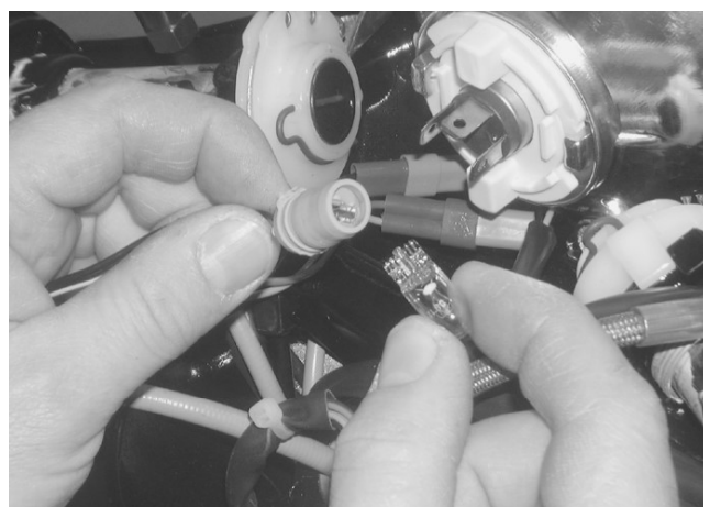
21.3. La bombilla de la luz de posición encaja a presión en su soporte.
