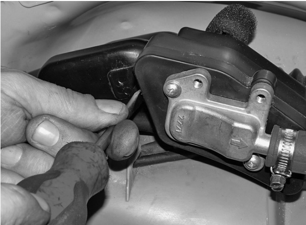
5.2a. Un solo tornillo asegura el filtro de aire anexo.
