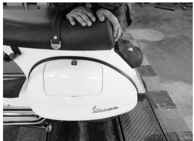
7. Haga rebotar la parte trasera del scooter para comprobar el funcionamiento de la suspensión trasera.
