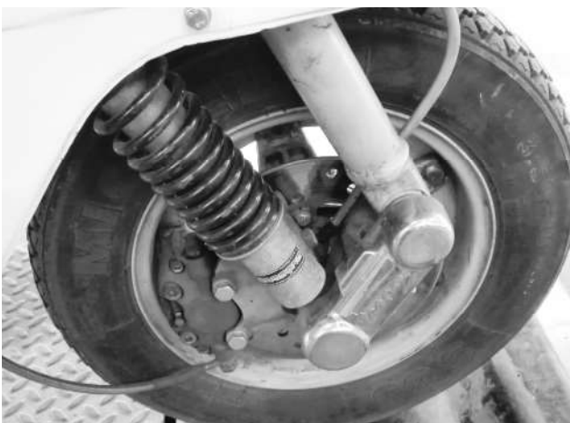
6. Inspeccione el área alrededor de la junta de la horquilla en busca de fugas de aceite.
