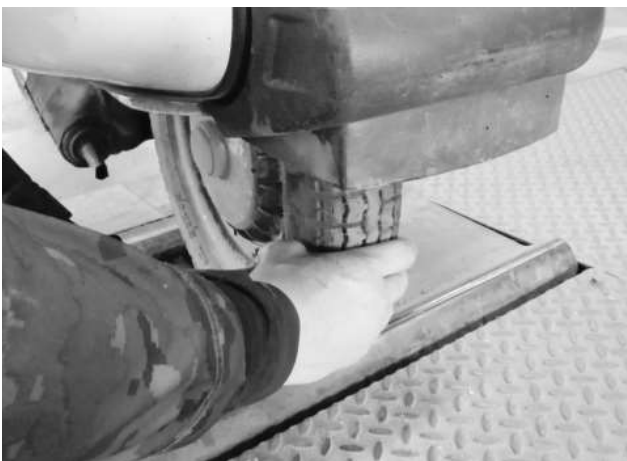
8. Sujete la rueda trasera para comprobar si hay holgura en los soportes del motor al bastidor.
