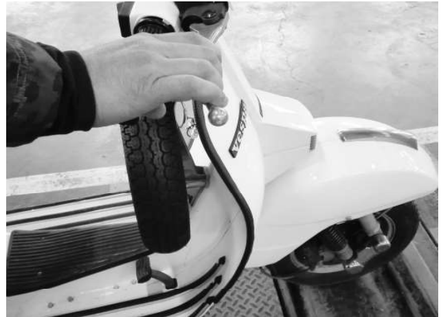
5. Sujetar el freno delantero y presionar la suspensión delantera hacia arriba y hacia abajo para comprobar su funcionamiento.
